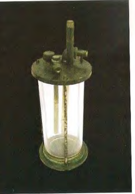
44. Εξαρτήματα χλωριωτή του εργοστασίου «Χλωρατόρ», στο Βερολίνο που λειτουργούσε με υγρό χλώριο (εγκαταστάθηκε γύρω στο 1956).
