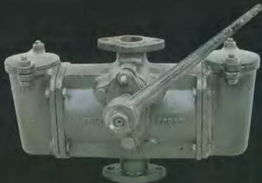
26. Χειροκίνητη αντλία με έμβολο, διπλής ενέργειας. Αντλούσε ποσότητα διπλάσια από αυτή της απλής τουλούμπας.
